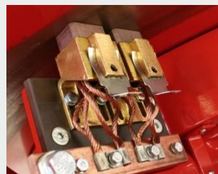
/ transfer de curent
